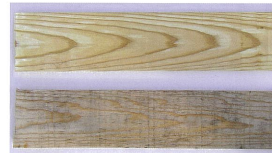
上：液体ガラス注入・コート材施工 下：未処理・無塗装
